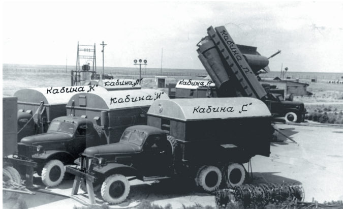
Общий вид радиолокационной станции наведения РСН-75
